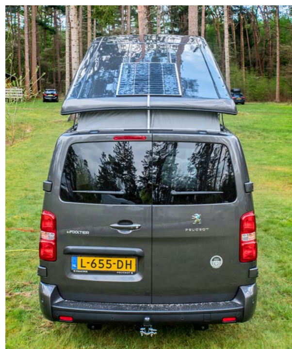
Op de camping plug je twee stekkers in. De een voor de verlichting en de koelkast, de ander voor het laten werken van de verwarming (via airco) en de radio. Opladen van de auto op een camping duurt circa zeven uur.
